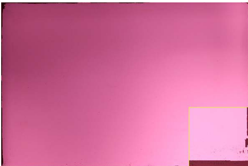
Une prise de vue de contrôle permet d'évaluer l'état de surface. On constate qu'il reste un peu de matrice sur le pourtour du capteur. Ceci est nécessaire pour ne pas risquer d'endommager la partie électronique située sur le pourtour du capteur ( zone bleue en bordure de la matrice). La surface est en moyenne débayerisée à 95 %.
